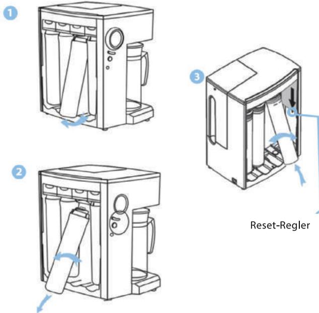
1. Schalten Sie die Stromversorgung ab und öffnen Sie die seitliche Abdeckung für Filter und Membrane(n).
