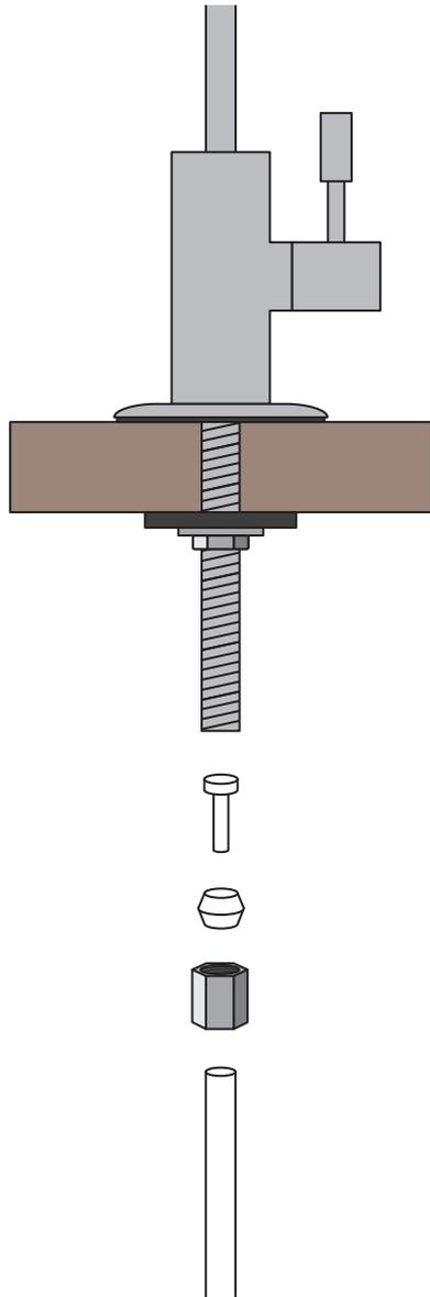
3.1 Schieben Sie die Mutter über den 1/4" Schlauch für Osmsoewasser.
