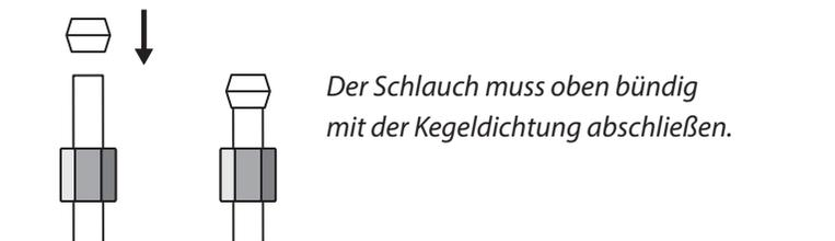
3.3 Stecken Sie die Stiftdichtung in den Schlauch.
